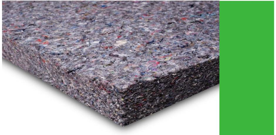
**Característica:** Tela no tejida fabricada con tecnología Airlay de fibras sintéticas recicladas, principalmente de poliéster, aglutinadas con fibras de poliéster bicomponente.
